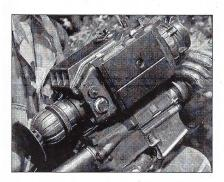
diger Dunkelheit und bei Nebel sind sie nahezu nutzlos: zudem bleiben gut getarnte Objekte unter allen Bedingungen unsichtbar. Aus diesem Grund gab die amerikanische Infanterie ein kompaktes Infrarot-Nachtsichtgerät in Auftrag, das etwa 2 kg wiegen sollte und sich wie ein Zielfernrohr auf dem Sturmgewehr montieren lässt (Bild).
