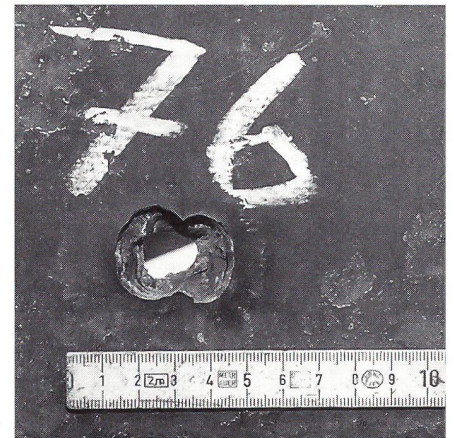
Einwandfreier Durchschuss in Panzerplatte.
