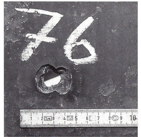
Einwandfreier Durchschuss in Panzerplatte.
