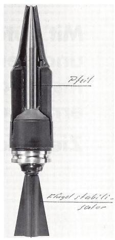
25 mm×137 mm-Pfeilgeschoss. Der Pfeil, bestehend aus Wolfram, ist auf maximale Durchschlagsleistung gegen Monoblock wie auch auf mehrlagige Ziele ausgelegt.
