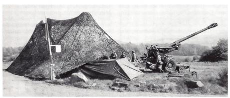
Feldhaubitze FH 155-1. Bedienung 8 Mann, Kaliber 155 mm, Schussweite 24/30 km, 6 Schuss pro Min, ein Hilfsantrieb ermöglicht Beweglichkeit im Stellungsraum.
