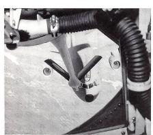
Der aufgeklappte und eingefahrene Boom mit den beiden Steuerflügeln.
