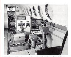
Blick in die Super King Air: Rechts der Arbeitsplatz des Kameraoperateurs, auf dem Boden die zwei Kameras und dazwischen der Turm des Rechners. (Foto: Schweizer Luftwaffe)
