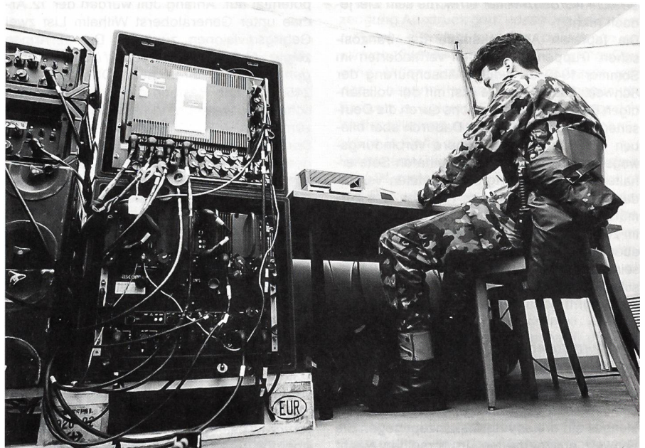
An jeden der automatischen Vermittler im IMFS können bis zu 96 Teilnehmer oder 16 Bündelverbindungen angeschlossen werden.
