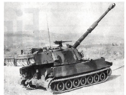
So sieht die kampfwertgesteigerte Panzerhaubitze M-109 äusserlich aus: längeres Geschützrohr, Flecktarnanstrich und «Rucksack» am Turmheck, der es ermöglicht, mehr Munition mitzuführen.
