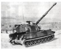
So sieht die kampfwertgesteigerte Panzerhaubitze M-109 äusserlich aus: längeres Geschützrohr, Flecktarnanstrich und «Rucksack» am Turmheck, der es ermöglicht, mehr Munition mitzuführen.
