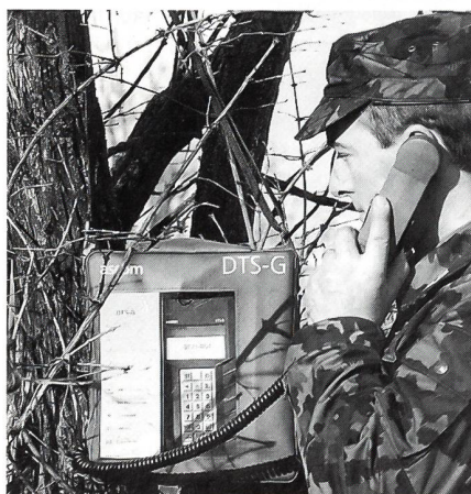
Moderne Endgeräte wie digitale Telefonstationen, Fax und Datenschlüsselungsgeräte gehören zum IMFS. Im Bild die digitale Telefonstation DTS-G für den Feldeinsatz.
