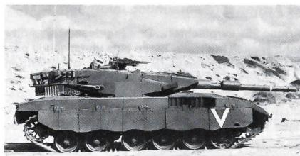
Der 61 t schwere Kampfpanzer Merkava Mk 3 ist das letzte Glied der Merkava-Entwicklungsreihe. Vier Männer bilden die Besatzung. Er verfügt über eine 120-mm-Glatrohrkanone. Der Panzer hat drei MG 7,62 mm, ein MG 12,7 mm (Optional) und einen Mörser von 60 mm, eine hochmoderne Feuerleitanlage sowie ein leistungsstärkeres Triebwerk (Teledyne Continental AVDS-1790-9 AR) und einen erheblich verbesserten ball Schutz (adaptierte Schutzmodule). Die Produktion des Mk 3 dürfte 1990 angelaufen sein.
