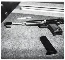
Der Sender wird in den Lauf der Waffe gesteckt. Durch das Betätigen des Abzuges wird er ausgelöst und trifft auf der Scheibe den Empfänger, welcher den Treffer exakt anzeigt.
