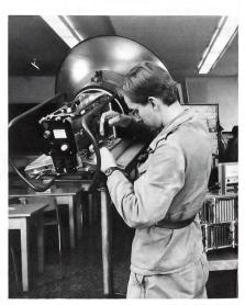
Gerätemechaniker reparieren das Kleinrichtstrahlgerät R-902.
