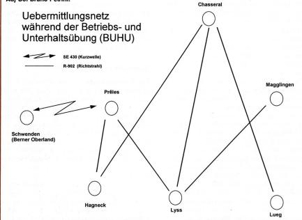
«Es ist wichtig», so Adj Uof Petrini, «dass die Störungssuche innerhalb eines Netzes geübt wird. Es ist nicht sinnvoll, wenn Gerätemechaniker nur an einzelnen Objekten Störungen suchen. Ist der Fehler erst einmal auf Stufe Gerät eingegrenzt, gestaltet sich deren Behebung im Normalfall nämlich einfach. Das Hauptproblem ist aber vielmehr herauszufinden, in welchem Gerät innerhalb einer Übertragungsstrecke der Fehler überhaupt liegt.»
