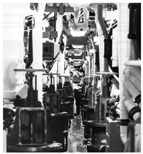
Diese Aufnahme zeigt das Abteil der 16 Raketensilos für die nuklear-strategischen Raketen «Trident» D-5 auf dem neuen britischen Raketen-U-Boot «HMS Vanguard». Insgesamt führt das Boot 16 Raketen mit einer Reichweite von über 7200 km mit.
