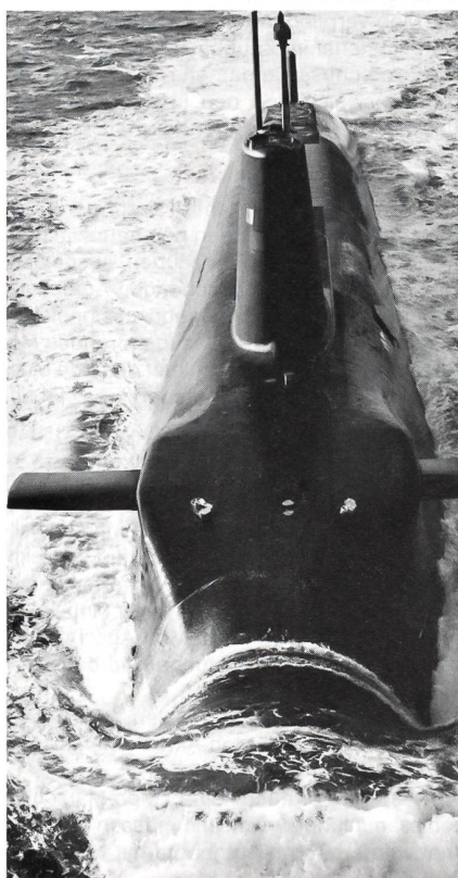
Das neueste britische Raketen-U-Boot: die atomgetriebene, 16 000 t (getaucht) verdrängende «HMS Vanguard». Sie ist das Leitschiff der insgesamt vier Boote umfassenden seegestützten Atomstreitmacht Englands. Das Boot führt 16 Interkontinentalraketen des amerikanischen Typs Lockheed «Trident» D-5 mit. Diese Raketen befinden sich in vertikalen Startsilos hinter dem Turm. Die Ruder vorne dienen der Höhen- resp Tiefensteuerung unter Wasser.
