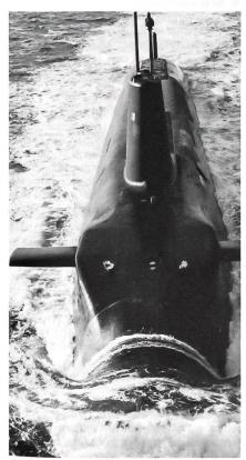
Das neueste britische Raketen-U-Boot: die atomgetriebene, 16 000 t (getaucht) verdrängende *«HMS Vanguard»*. Sie ist das Leitschiff der insgesamt vier Boote umfassenden seegestützten Atomstreitmacht Englands. Das Boot führt 16 Interkontinentalraketen des amerikanischen Typs Lockheed *«Trident»* D-5 mit. Diese Raketen befinden sich in vertikalen Startsilos hinter dem Turm. Die Ruder vorne dienen der Höhen- resp Tiefensteuerung unter Wasser.
