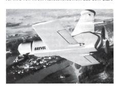
container heraus beschleunigt. Nach dem Abwurf des Starttriebwerks übernimmt das Marschtriebwerk – ein Zweizylinder-Zweitakt-Boxermotor mit 22 kW von Fichtel & Sachs – den Antrieb. Dieser Testflug wurde von der Bundeswehr und STN Atlas Elektronik im Auftrag des von Matra und STN Atlas Elektronik gegründeten Eurodrone-Konsortiums durchgeführt. Die Brevel hat eine Flugausdauer von 5 h; eine Exportversion soll 9,5 h in der Luft bleiben können.
