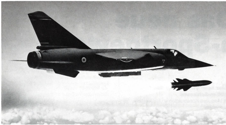
Abschuss des Antiradar-Flugkörpers ARMAT vom Kampfflugzeug MIRAGE F1 aus.
