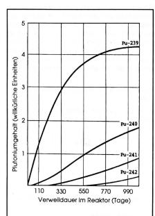
Figur 1. Gehalt der verschiedenen Pu-Isotope in Abhängigkeit der Verweildauer im (Leichtwasser)-Reaktor. (Nach "Scientific American" Juni 1977).
