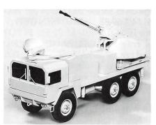
Eine mobile Ahead-Luftabwehreinheit. Bestehend aus Revolverkanone 35/1000 und der Feuerleiteinheit. (Modell der Oerlikon-Contraves)
