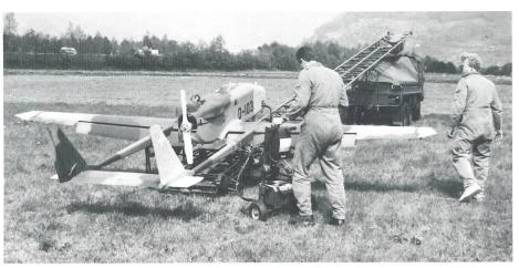
Die für die Bodenbeobachtung vorbereitete Drohne ADS-95, Fabrikat Oerlikon-Contraves, wird startklar gemacht.
