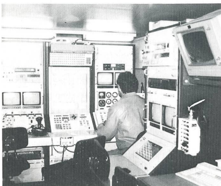
Blick in den Leitstand der Drohne. Der Pilot überwacht und steuert deren Flug. Auf dem Kartenausschnitt ist die Position und Flugrichtung permanent ersichtlich.
