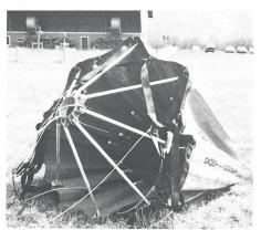
Der Aussenlastbehälter «Bambi-Bucket». Mit ihm können bis 2500 Liter Löschwasser geflogen werden.
