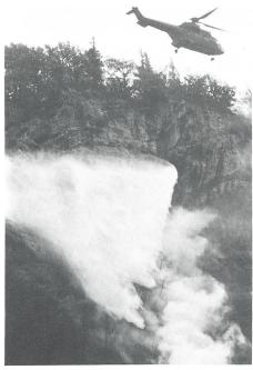
Der Abwurf des Löschwassers mittels «Bambi-Bukket» über einem Flächenbrand.
