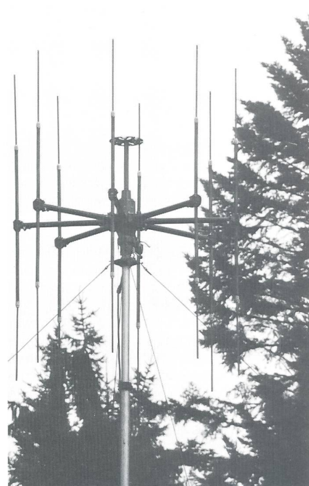
Antennenkopf mit Dipolen des Peilers P-725/m
