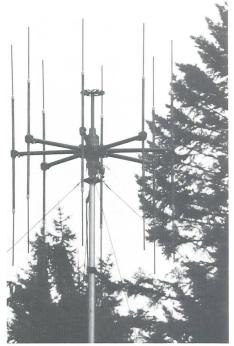
Antennenkopf mit Dipolen des Peilers P-725/m
