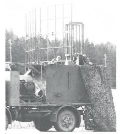
Inbetriebnahme eines Störsenders SE-600
