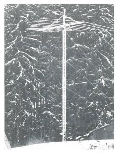
Die HF-Antenne «Logper-1007», Frequenzbereich 13 bis 30 MHz.
