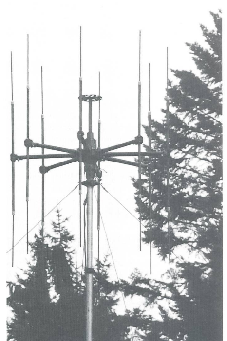
Antennenkopf mit Dipolen des Peilers P-725/m
