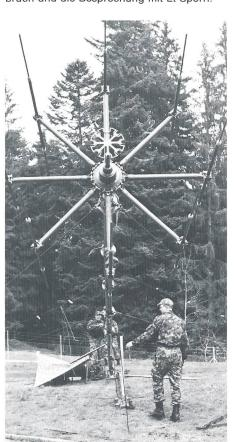
Aufbau der Peilantenne des Peilers P-725/m
