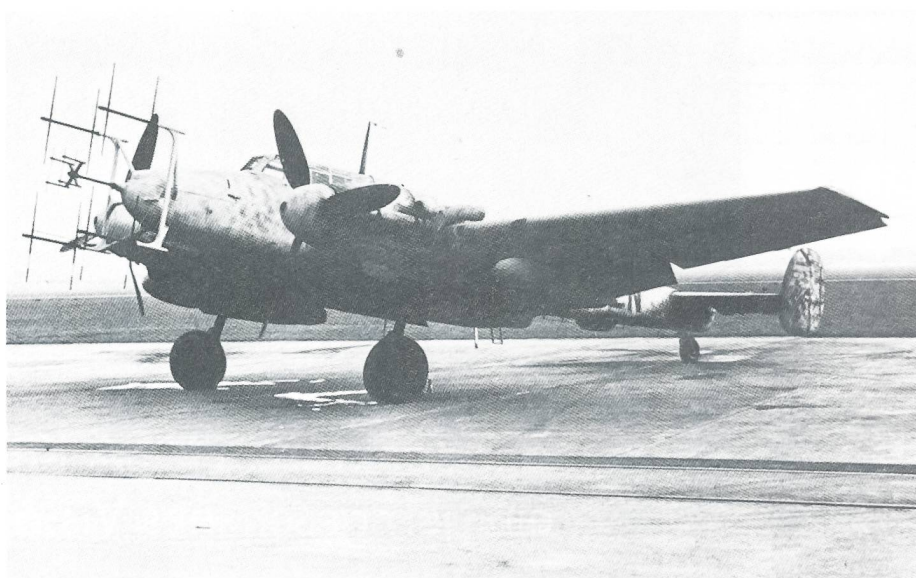
Der in Dübendorf am 28. April 1944 notgelandete Nachtjäger. Innere Antennenanlage für den Lichtensteinradar FuG 202 (Nahefassung bis 200 m), äussere für FuG 220 (max bis 6 km). Bild aus Buch von E. Wetter, Verlag Huber Frauenfeld, «Geheimer Nachtjäger in der Schweiz».
