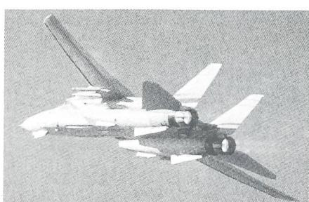
Der Schwenkflügler F-14 TOMCAT war ursprünglich für den Flottenschutz gegen Luftangriffe mit Abstandswaffen gedacht. Der zweiplätzige, zweistrahlig-e Schwenkflügler verfügt über ein Doppelleitwerk. Auffällig sind im weiteren die Kielflossen, die schräggestellten Lufteinläufe, deren Oberkante weit nach vorne gezogen ist.
