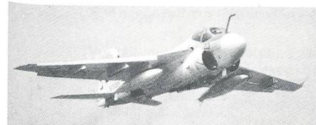
A-6 INTRUDER: das zweisitzige, allwettertaugliche Angriffsflugzeug ist speziell für Angriffe auf Punkziele ausgelegt. Der Pilot und Navigator/Bomben-Schütze sind im Cockpit Seite an Seite untergebracht. Die Triebwerke sind am «Bauch» links und rechts in der vorderen Hälfte des Rumpfes untergebracht.
