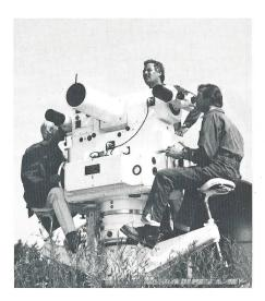
«Electronic-Optical Tracking System») Kinotheodoliten zur Flugbahnvermessung von entfernten bewegten Objekten. Die ersten zwei 1957 beschafften Geräte (C) waren mit analogen Anzeigen ausgerüstet, was eine relativ aufwendige Auswertung erforderte. 1967 wurden zwei weitere, digitale Geräte (E) beschafft und 1973 die zwei ersten auf digitale Anzeige umgebaut.
