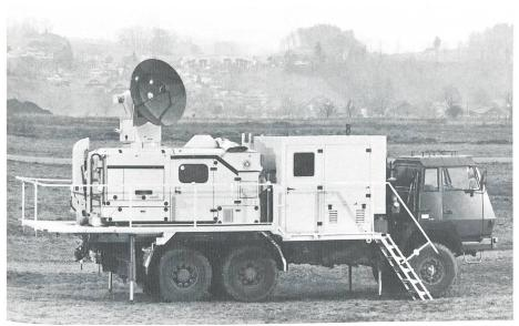
Mit dem seit 1993 im Einsatz stehenden IRIS-Flugbahnvermessungsradar können Geschosse bis über 40 km automatisch verfolgt und eingemessen werden.
