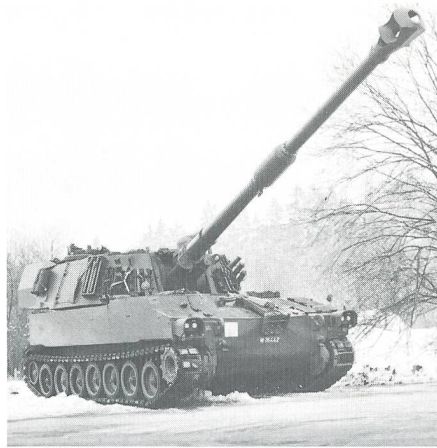
15,5 cm Pz Hb (früher M 109) mit mehreren bei der K+W Thun entwickelten Waffenkomponenten und leistungsgesteigertem Langrohr (über 8 m) diente als Versuchsplattform für die «BISON»-Ballistik.
