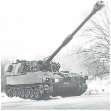
15.5 cm Pz Hb (früher M 109) mit mehreren bei der K+W Thun entwickelten Waffenkomponenten und leistungsgesteigertem Langrohr (über 8 m) diente als
