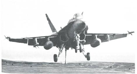
Eine F/A-18C «Hornet» der Fighter/Attack Squadron 87 «Golden Warriors» landet auf dem Deck des US Flugzeugträgers «USS Theodore Roosevelt» (CVN-71). Sie kehrt von einem Einsatz zur Überwachung der «No Fly Zone» über Bosnien-Herzegowina zurück. Gut sichtbar sind der Fanghaken zwischen dem Fahrwerk sowie die über das Flugdeck gespannten Fangseile. Die F/A-18 C ist mit einer Luft-Luft-Lenkwaffe «Sparrow» sowie an den Flügelenden mit «Sidewinder»-Luft-Luft-Lenkwaffen bewaffnet.
