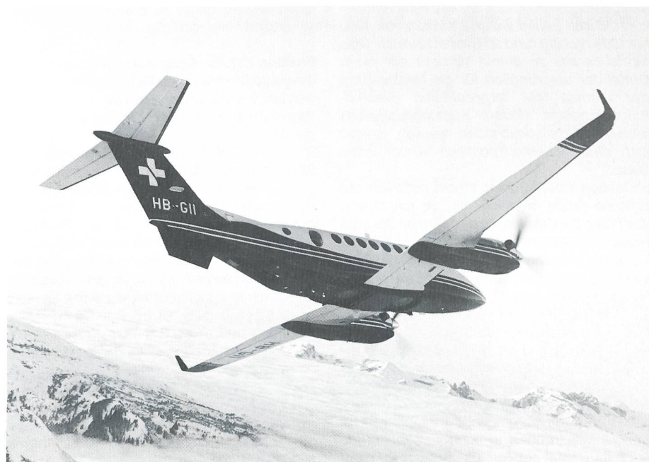
Neues Vermessungsflugzeug Super King Air 3500 HB-GII vor den Churfürsten. Auf der Unterseite des Rumpfs sind die Kamerasysteme eingebaut. Foto: Militärflugdienst Dübendorf
