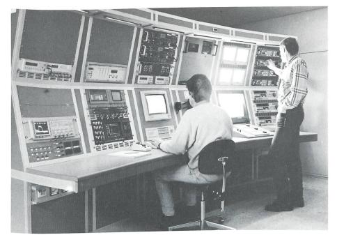
Ballistische Messtechnikzentrale einer Schiessanlage.
