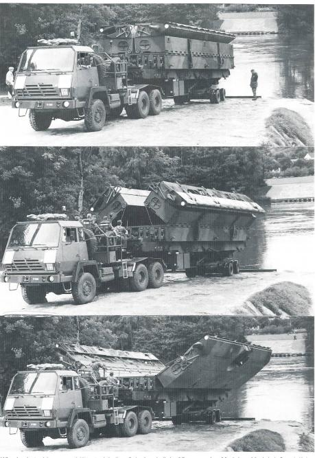
Wie eine Lotosblume *«entblättert»* sich die *«Schwimmbrücke 95»*, wenn sie – Modul um Modul ab Spezialfahrzeug – ins Wasser gelassen wird.
