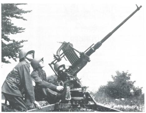
20-mm-Flabkanone 1937 Oerlikon in Feuerstellung. Schussfolge, 280 Schuss/min. Geschoss-Anfangsgeschw, Vo = 830 m/s. Praktische maximale Schussdistanz auf Flugzeuge: 1500 m
