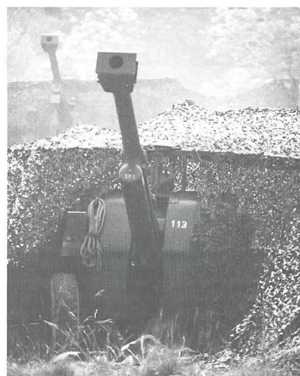
Zwei 10,5-cm-Haubitzen L30, bereit in der Feuerstellung für das nächste Artillerie-Schiessen. Mit diesen Geschützen sind die Abteilungen des Geb AK ausgerüstet.
