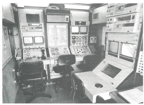
ADS-90-Einsatzkontrollstelle mit vier Arbeitsplätzen. Von links für Nutzlastbediener, Navigation/Flugsicherung, Pilot und Benützer (Nachrichten-, Artillerie- oder Fliegerleitoffizier).
