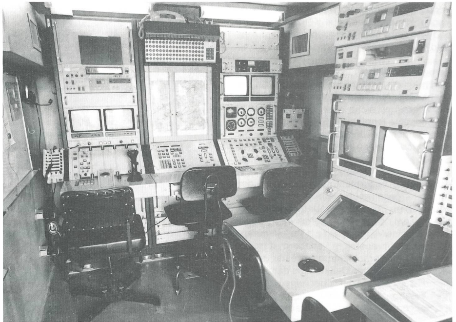
ADS-90-Einsatzkontrollstelle mit vier Arbeitsplätzen. Von links für Nutzlastbediener, Navigation/Flugsicherung, Pilot und Benutzer (Nachrichten-, Artillerie- oder Fliegerleitoffizier).
