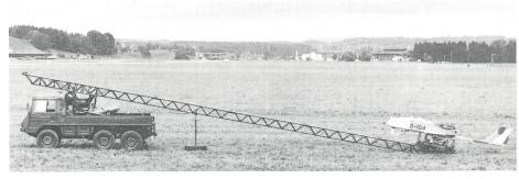
Hydromechanisches Startkatapult, aufgebaut auf Geländefahrzeug Pinzgauer 6×6. Startbereite Drohne am hinteren Ende des Katapultes.
