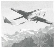
Prototyp-Flugkörper Ranger mit hydraulischen Landekufen. Hersteller Eidg Flugzeugwerke Emmen.
