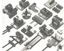
Dazu die kompatiblen **Verformungs-Werkzeuge**im Baukastensystem
