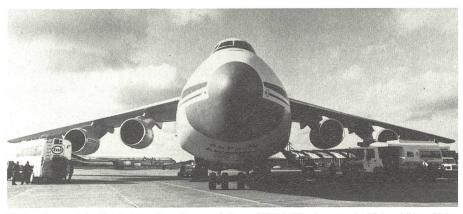
Für den Transport der Nutzlast das Grossflugzeug **Antonov AN 124**, Flügelspannweite 73,3 m, Länge, 69,1 m, Höhe 25 m und Abfluggewicht 405 Tonnen (max).
