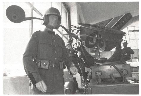
Horchposten mit «verlängerten Ohren». Solche Hörrohre wurden Ende der dreissiger Jahre versuchsweise eingesetzt. Im Hintergrund ein Siemens-Horchgerät «Elascop» aus dem Jahre 1936.
