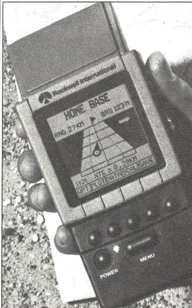
Der Trooper wurde speziell für militärische Anwendungen entwickelt. Jetzt ist die Navigation mit GPS auch bei Regen, Schnee und Minustemperaturen, Tag und Nacht möglich. Der Trooper GPS besitzt ein sehr robustes Gehäuse, er ist 87x187x67 mm klein, 980 g leicht, wasserdicht, und wird von Batterien gespiesen. Verlangen Sie unseren Detailprospekt!
