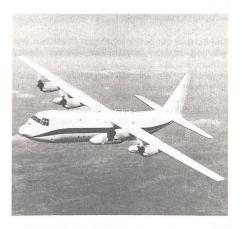
lison GMA 2100 Turboprob-Motoren ausgerüstet werden, die gleichen übrigens, wie sie beim Regionalreiseflugzeug Saab 2000 Verwendung finden. Zudem soll der C-130J mit einem Zwei-Mann-«Glas»-Cockpit (dh mehrere Bildschirme) ausgerüstet werden.
