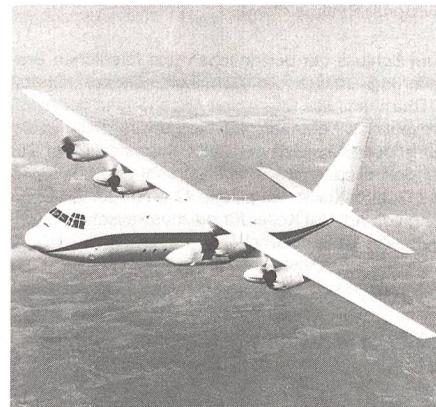
lison GMA 2100 Turboprop-Motoren ausgerüstet werden, die gleichen übrigens, wie sie beim Regionalreiseflugzeug Saab 2000 Verwendung finden. Zudem soll der C-130J mit einem Zwei-Mann-«Glas»-Cockpit (dh mehrere Bildschirme) ausgerüstet werden. mk
