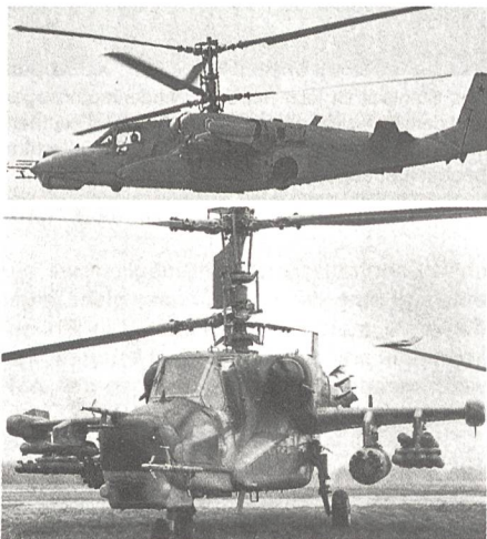
Das ungewöhnliche Rotor-Layout, der aerodynamisch geformte Rumpf, das Leitwerk und die Stummelflügel mit den Behältern am Ende machen die Erkennung des Ka-50 HOKUM relativ einfach (oberes und unteres Bild).
