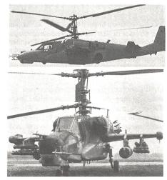
Das ungewöhnliche Rotor-Layout, der aerodynamisch geformte Rumpf, das Leitwerk und die Stummelflügel mit den Behältern am Ende machen die Erkennung des Ka-50 HOKUM relativ einfach (oberes und unteres Bild).
