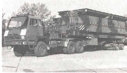
Die Fahrzeuge der «Schwimmbrücke 95» wurden helvetisiert. Die Brückenmodule (und deren Tarnbemalung) entsprechen dem original «Pont flottant motorisé» der französischen Armee.
