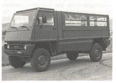
Der Militärlieferwagen 2 t «DURO», 4×4 geländegängig, 4-Gang-Automat. 6 Zyl, VM-Diesel, 110 kW bei 4200 U/min.
