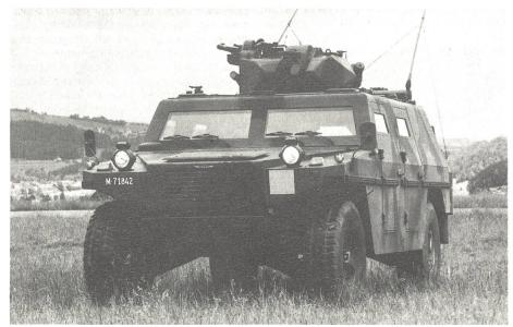
Leichtgepanzertes «Mowag»-Aufklärungsfahrzeug. Höchstgeschwindigkeit 105 km/h, Dieselachtzylinder 6,2 Liter, 150 PS.
