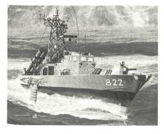
wärtigen Plänen sollen sie 1993 in Dienst gestellt werden. Ihre Einsatzverdrängung liegt bei 63 ts, die äusseren Abmessungen belaufen sich auf 24,60 m Länge und 7 m Breite. Ihre Höchstgeschwindigkeit wird etwa 50 kn betragen. Die Bewaffnung besteht aus vier Mitsubishi-SSM 1-B-Schiff/Schiff-FK (offensichtlich ein Derivat der amerikanischen HARPOON) und einem 20-mm-Vulcan-Phalanx-Rohrwaffensystem.
