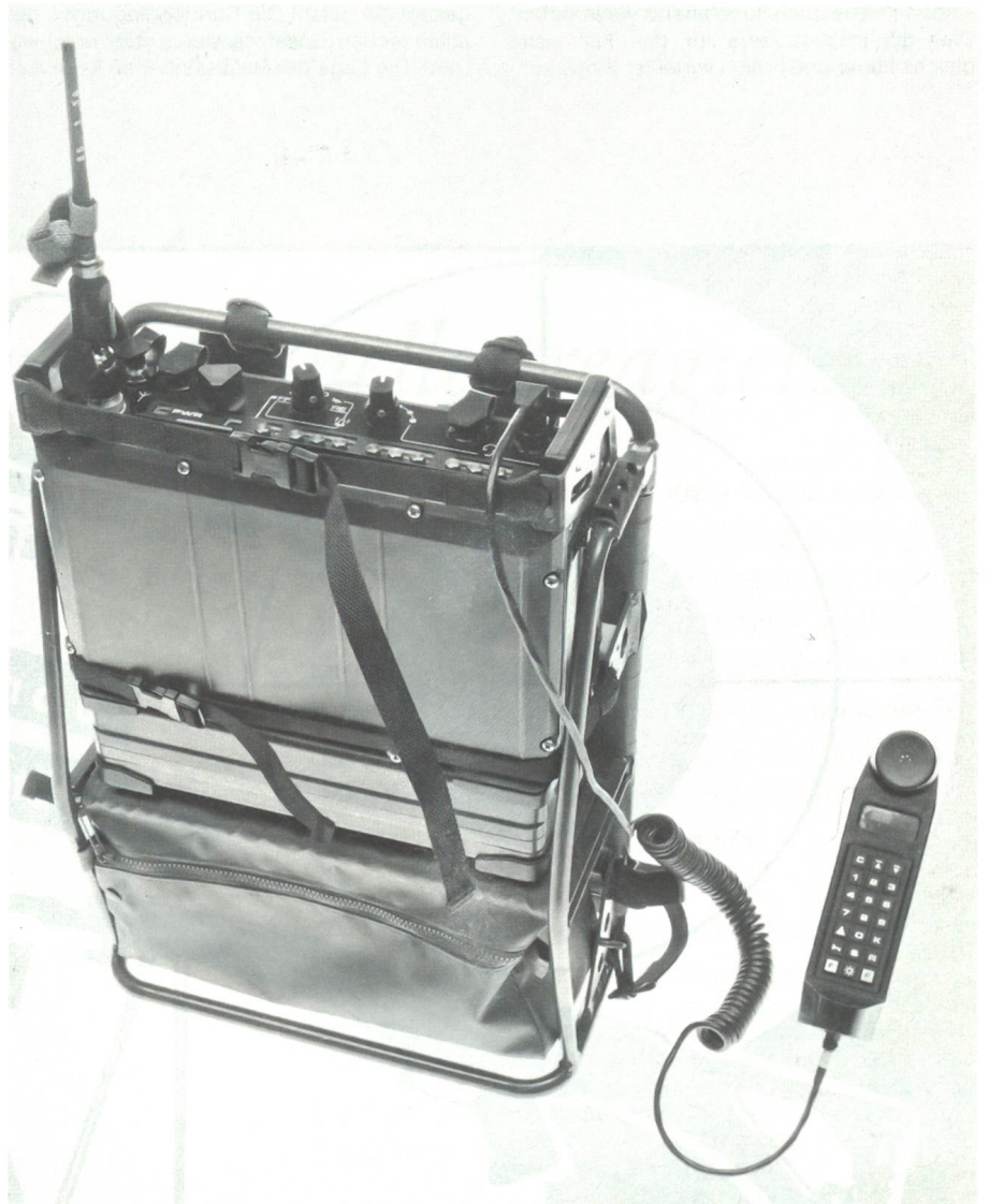
Die FF-Truppen erhalten ab 1992 das neue Funkgerät SE 225. Jedes einzelne Gerät kann die Funktion eines automatischen Relais übernehmen, was in unserem schwierigen Gelände erstmals sichere weitreichende Verbindungen erlaubt.
