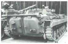
Die ehemalige NVA hatte 1115 der sowjetischen Schützenpanzer BMP-1. Der 13,6 t schwere Spz mit 2 Mann Besatzung kann 9 Pz Gren transportieren. Er ist schwimmfähig und mit einer 73-mm-Glattrohr-Kanone und einem Maschinengewehr 7,62 mm bewaffnet. Das Grundmodell ist mit dem Pzaw-Lenkwaffen-System AT-3 SAGGER bestückt. Die Panzergrenadierverbände in den fünf neuen Bundesländern erhalten diesen Spz. Eine Kampfwertsteigerung mit dem System AT-4 (Pzaw-Lenkwaffen SPIGOT und SPANDREL) ist vorgesehen.
