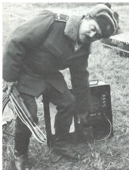
Vorführung der Ausbildung mit einem Schiesssimulator. Der Monitor zeigt die Ziel- wie die Trefferlage an. Das Gerät soll sich für alle Infanteriewaffen eignen.
