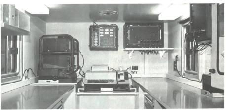
Blick in die Auswertekabine mit der Klimakammer ganz rechts zur Sondeneichung, hinten an der Wand von rechts Rechner, Ersatzbedienungskonsole und Übermittlungsgeräte. In der Mitte unten der Fernschreiber.
