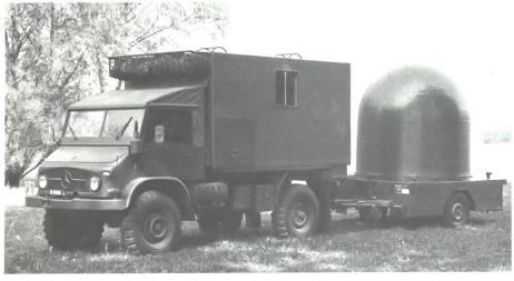
Das Zugfahrzeug Unimog S mit Auswertekabine und dem Radaranhänger (Telemetrieeinheit). Mit der Telemetrieeinheit werden die Temperatursignale empfangen und die Abtriftung der Ballonsonde gemessen.
