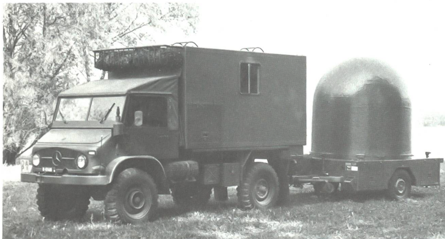
Das Zugfahrzeug Unimog S mit Auswertekabine und dem Radaranhänger (Telemetrieinheit). Mit der Telemetrieinheit werden die Temperatursignale empfangen und die Abtriftung der Ballonsonde gemessen.
