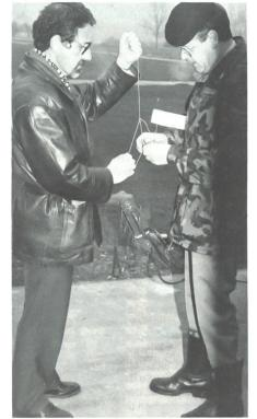
Herr Brossi der Firma Meteolabor zeigt zusammen mit Adj Uof Zangger die Befestigung der Sonde an der Ballonschnur.
