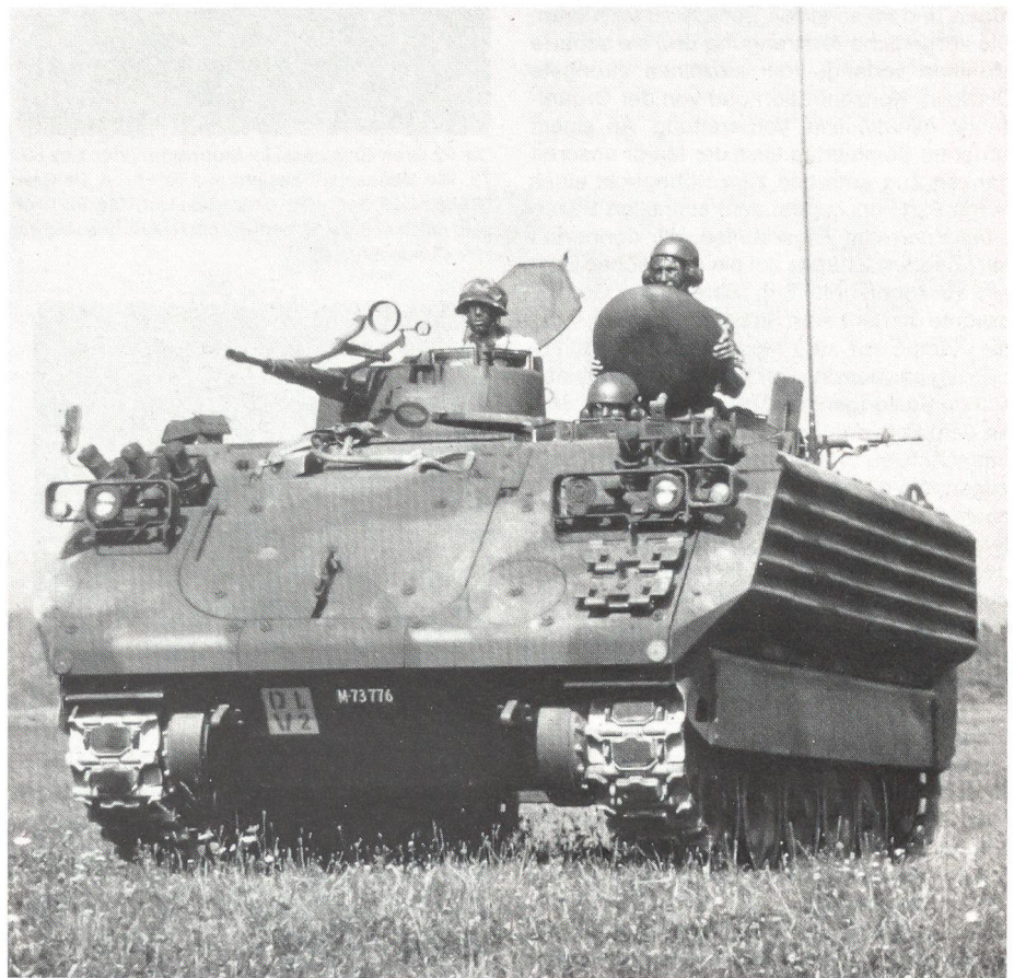
Mit dem Rüstungsprogramm 89 wurde die Kampfwertsteigerung von 316 Spz und 66 Kdo Spz (132 Mio Fr) beschlossen. Beim abgebildeten Spz 63/89 wurde vor allem der Schutz der Fahrzeuginsassen und die Beweglichkeit vergrössert. Damit soll der Pz 87 Leo 2 im Gefecht begleitet werden können. Das Programm läuft bis Ende 1993.
