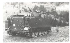
Feuerunterstützung mit der Hispano 20-mm-Kanone. Wirkungsdistanz bis 1200 m gegen harte und 2000 m gegen weiche Ziele. Feuergeschwindigkeit 750 bis 800 Schuss/min.
