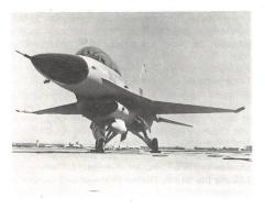
unter anderem mit einem APG-68-Radar, ALR-56M-Radarwarnempfänger, einem wesentlich modifizierten ALE-47 Chaff/Flare System ausgerüstet. Ausserdem stehen der Block-50-Version verbesserte Möglichkeiten, die Anti-Radar-Lenkwaffen vom Typ HARM (High Speed Anti Radiation Missile) einzusetzen, zur Verfügung.
