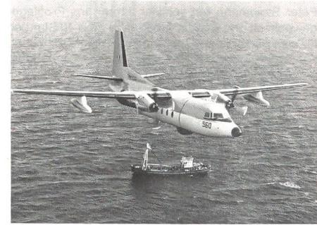
waffnung besteht grundsätzlich aus acht Torpedos. Gegen Schiffe können zudem Harpoon-Lenkwaffen abgefeuert werden. Die Einsatzdauer wird von Fokker mit 10 Stunden angegeben. Der Vorgänger der Maritime Enforcer Mk.2 steht zurzeit bei acht Nationen als Seeüberwachungs- und U-Bootbekämpfungsflugzeug im Einsatz.
