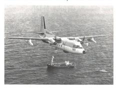
waffnung besteht grundsätzlich aus acht Torpedos. Gegen Schiffe können zudem Harpoon-Lenkwaffen abgefeuert werden. Die Einsatzdauer wird von Fokker mit 10 Stunden angegeben. Der Vorgänger der Maritime Enforcer Mk.2 steht zurzeit bei acht Nationen als Seeüberwachungs- und U-Bootbekämpfungsflugzeug im Einsatz.
