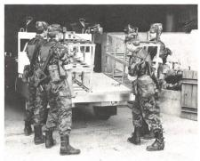
Sanitäts- und Leitungsbauwagen müssen über genau passende Zusatzausrüstungen verfügen. Darum werden hier (und nur hier!) Bundesbeiträge ausbezahlt. Ein als Leitungsbauwagen vorgesehener Lieferwagen wird (von den Asp) mit den Bauteilen aus dem Korpsmaterial bestückt und mit der Zusatzausrüstung des Halters befestigt.
