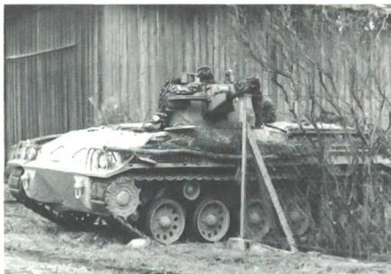
Ein Schützenpanzer Saurer 4K3FA im Sicherungseinsatz. Der 12,5 Tonnen schwere Spz ist mit einer 20 mm Bordkanone und einem 7,42-mm-Maschinengewehr bewaffnet.
