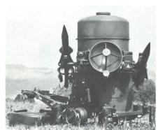
Der einsatzbereite Lenkwaffenwerfer. Mit dem mobilen Fliegerabwehrsystem Rapier können Luftziele bis in den mittleren Höhenbereich (Reichweite 7 km) bei Tag, in der Nacht und bei schlechtem Wetter bekämpft werden.
