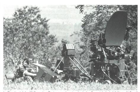
Im Einsatz wird das Waffensystem Rapier normalerweise durch den Feuereinheitschef (höherer Uof) und einem Lenkwaffensoldat bedient, die im Dauereinsatz periodisch abgelöst werden müssen. (Von links nach rechts) Bedienungsgerät, Richtgerät, Folgeradar.
