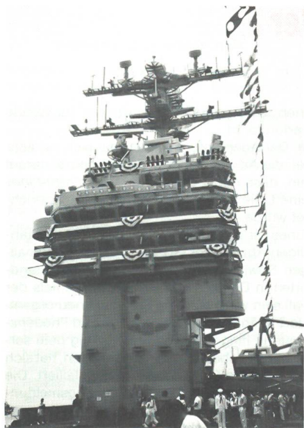
Der Kommandoturm, auch «Insel» genannt, des Flugzeugträgers «USS George Washington» ist seitlich am Flugdeck rechts (steuerbord) platziert. Er umfasst 8 Decks. Das 5. Deck (der sogenannte 07 level, als untere Fensterreihe erkennbar) ist die Admiralsbrücke, das 6. Deck ist die eigentliche Brücke, auch Navigationsdeck genannt, von welchem aus der Kapitän sein Schiff führt. Zuoberst befindet sich der «Kontrollturm», von wo aus der Flugverkehr auf dem Deck geführt wird.
