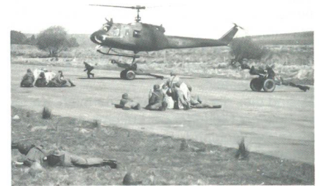
Die deutsche Luftlande Artillerie Batterie 9 beim Pickup mit einem deutschen Helikopter Bell-UH-1D. Die Haubitze 105 mm wird an einen Helikopter gehängt, die Mannschaft und das Material an einen zweiten. Die leeren Lastwagen UNIMOG fahren auf dem Landweg an den Bestimmungsort oder werden mit einer Herkules transportiert.
