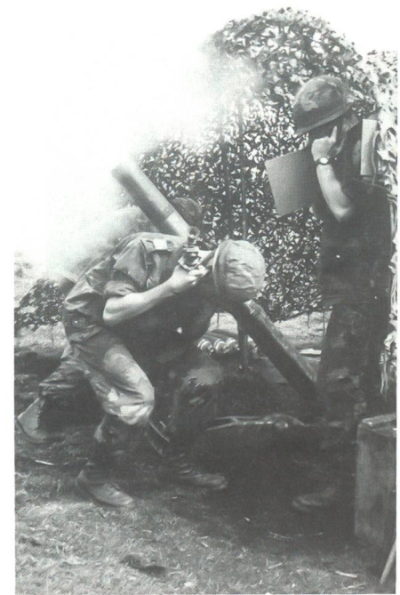
Eine Gruppe des belgischen Minenwerferzuges in Aktion. Das Zielgerät hält der Richtschütze in den Händen. Es wird bei jedem Schuss weggenommen und dann wieder aufgesetzt.
