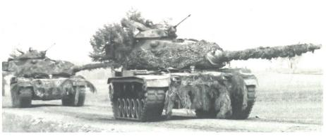
Panzerzug mit Kampfpanzern M-60A3 (Kampfgewicht 51,5 t; Besatzung 4 Mann; Bewaffnung: 10,5 Kanone, 12,7-mm- und 7,62-mm-Maschinengewehre, Motor: 550 kW; Höchstgeschwindigkeit: 48 km/h; Fahrbereich: 500 km auf der Strasse). Sie waren die Gegner der schweizerischen Panzerjägerkompanie.
