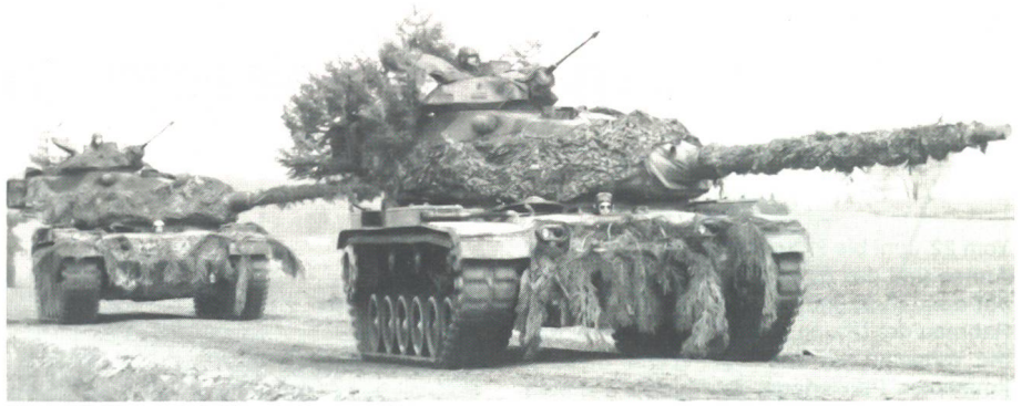
Panzerzug mit Kampfpanzern M-60A3 (Kampfgewicht 51,5 t; Besatzung 4 Mann; Bewaffnung: 10,5 Kanone, 12,7-mm- und 7,62-mm-Maschinengewehre, Motor: 550 kW; Höchstgeschwindigkeit: 48 km/h; Fahrbereich: 500 km auf der Strasse). Sie waren die Gegner der schweizerischen Panzerjägerkompanie.
