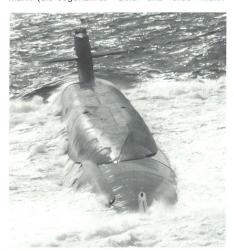
Das Bild zeigt das neueste Lenkwaffen-U-Boot «USS Kentucky» der US Navy auf einer Fahrt im Atlantik. Deutlich erkennbar ist hinter dem Turm das erhöhte Deck, in welchem vertikal die 24 Startrohre für die «Trident 2»-Raketen untergebracht sind. Die seitlich des Turmes angebrachten «Flügel» dienen der Tiefensteuerung des Bootes unter Wasser. (Foto «US Navy»)
