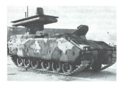
Zielauffassung und -verfolgung befindet sich oberhalb der Abschussvorrichtung. Der Laser zur Entfernungsmessung und Flugkörper-Steuerung ist vorn links oben an der Wanne angebracht. Der FK (Rakete) hat eine Länge von 2845 mm, einen Durchmesser von 162 mm und ein Gewicht von 77 kg. Der Feststoffmotor beschleunigt die Rakete so, dass ein KE-Penetrator mit 1609 m/sec auf das Ziel auftrifft.
