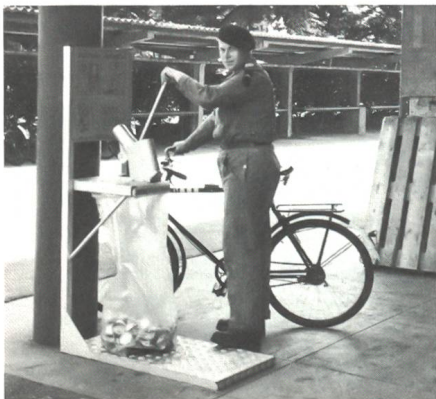
Eine Alu-Dosen-Pressen der Igora-Genossenschaft für Alu-Dosen-Recycling in Zürich: Der Waffenplatz Thun ist mit 16 solchen Stationen ausgestattet.
